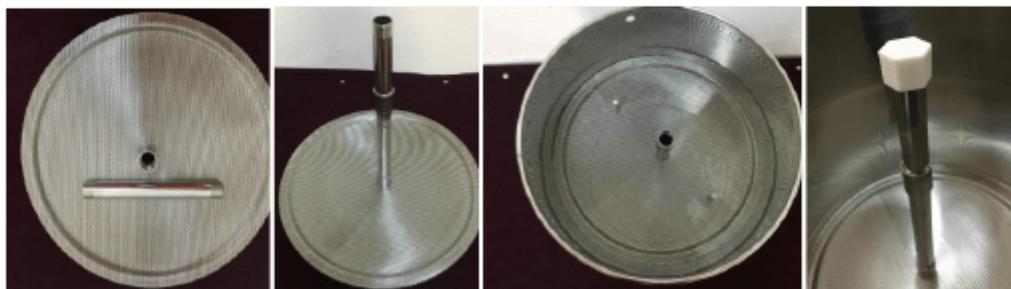
Перфорированный диск с одним отверстием в центре располагается на дне бункера для солода. Перед тем, как установить его на дно бункера, присоедините к нему трубку перелива.
