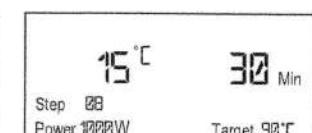
Таким образом установите температуру, мощность и время для каждого шага.
